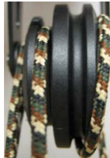
Exemple 2 : alignement incorrect.
