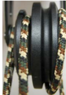
Exemple 2 : alignement incorrect.
