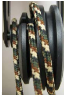
Exemple 1 : alignement incorrect.
