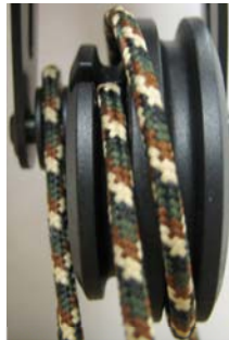
Exemple 1 : alignement incorrect.
